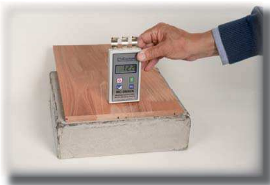
Mittaussyvyys 10 mm -Mittaa ainoastaan puulattiaa
