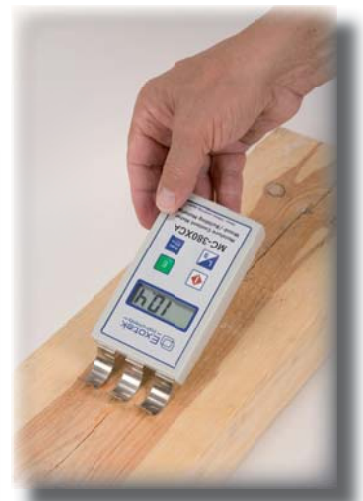
Mittaussyvyys 100 mm - Havaitsee kosteusvaihtelut puupalkissa
