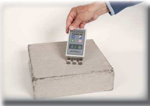
Mittaussyvyys 100 mm - Skannaa koko betonilaatan
